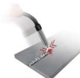
Deze speciale functie zorgt voor geprogrammeerd branden van de lasdraad (draad smelt niet vast) en bereidt de draad optimaal voor op de volgende ontsteking.
